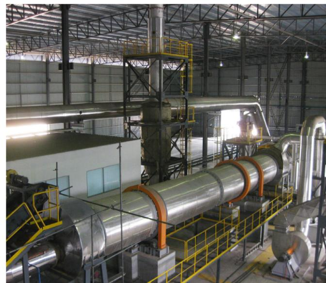
水份在20%以上的廢棄物需先在乾燥機烘乾，才能投入造粒機造粒成型。圖為頂鋒研製的乾燥機。
