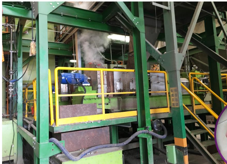
SRF經過衍生燃料技術的轉換，發電效率提升到35%以上，不但符合環保要求，經成型均質化後，燃燒溫度達攝氏1,000度以上，就不會產生戴奧辛。圖為擠壓式成型機運作畫面。
