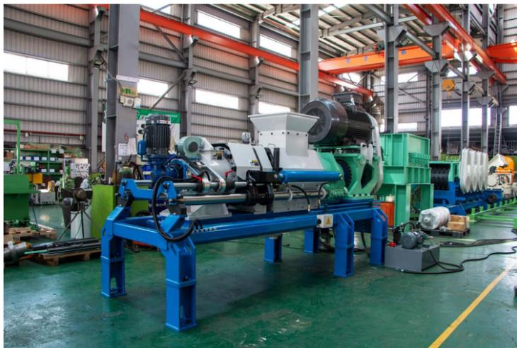
頂鋒的擠壓式成型機寬度5公尺，長度僅3公尺，放置一般廠房也不擁擠，搭配全自動化介面操作，節能環保一兼二顧。
