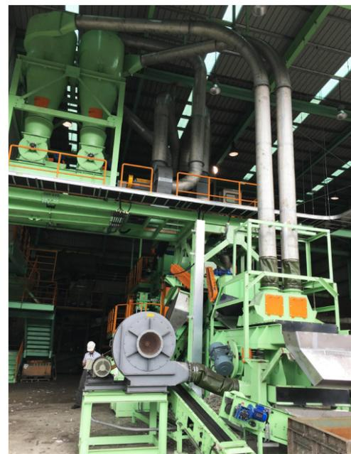
頂鋒特別開發出「震動式分選機」供連泰使用，造粒前先將細小雜質篩選出8到9成，再送入擠壓機成型，透過每隔2、3個月定期保養，機械損耗果然明顯好轉。
